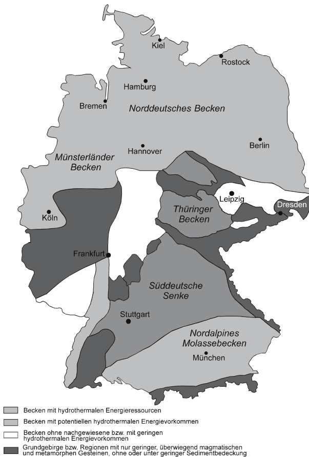
Abb. 2.53 Gebiete mit hydrothermalen und potenziellen hydrothermalen Energievorräten in Deutschland (nach /2-13/)
